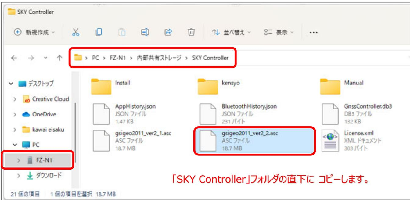
FZ-N1に登録した『gsigeo2011\_ver2\_2.asc』をTrimble SKY Controllerで利用するにはプロジェクト作成の際に使用するジオイドファイルのバージョン選択が必要です。
